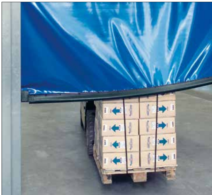
Благодаря инновационному замыкающему профилю SoftEdge ворота не выходят из строя после наезда
